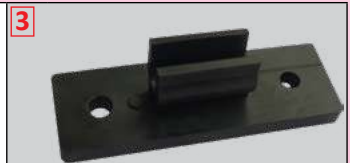
Kolbenhalterung, PA66 Kunststoff, 2 Schraub- oder Klebemontage, für Kolben-Ø 5-6mm, max. Temperatur 80°C
