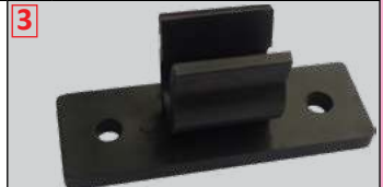
Kolbenhalterung, PA66 Kunststoff, 2 Schraub- oder Klebemontage, für Kolben-Ø 8mm, max. Temperatur 80°C
